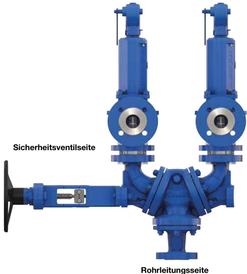
Wechselventile dienen dazu, zwei Sicherheitsventile über eine Rohrverbindung an ein Drucksystem anzuschließen, um die Anlagenverfügbarkeit zu erhöhen. Dabei ist ein Sicherheitsventil in Betrieb und ein Sicherheitsventil ist auf Standby.
