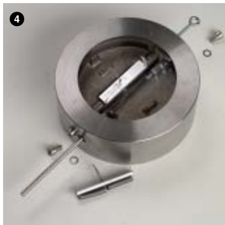
Placer de nouveaux ressorts de fermeture avec tôle de tension, monter les axes d'articulation.
