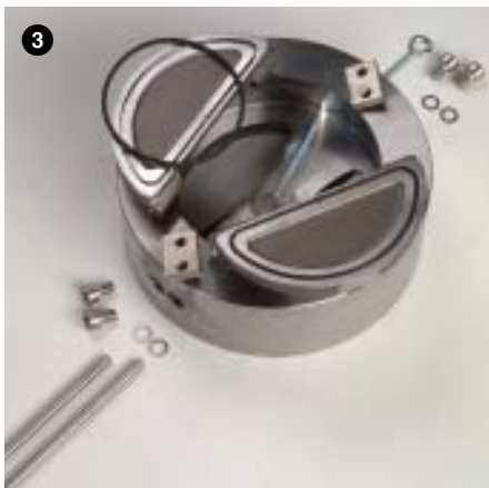
Sortir les ressorts de fermeture, les disques de clapet, les plaques et les joints (si présents).
