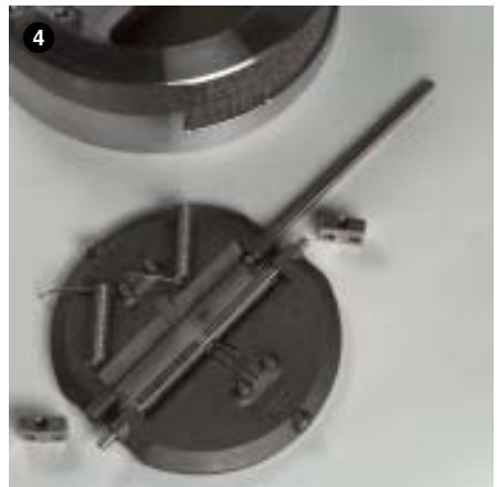
Déposer les supports d'articulation, couvrir les ressorts et sortir les axes d'articulation.
