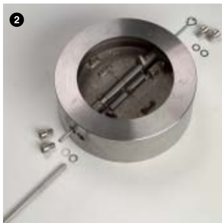
Desserrer les boulons, couvrir les ressorts, sortir les axes d'articulation.
