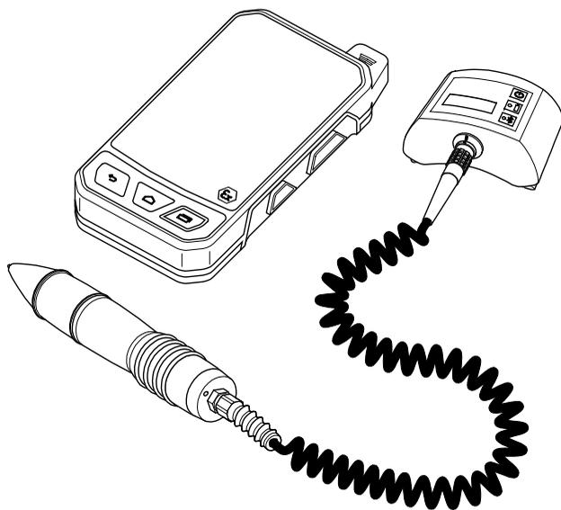
Appareil de contrôle de purgeurs
