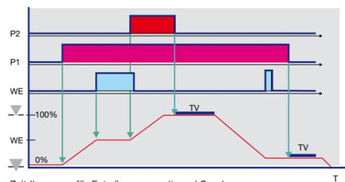
Zeitdiagramm für Entwässerung mit zwei Sonden
