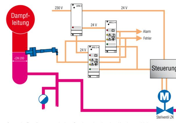
Geregelte Entwässerung mit einer Sonde und optionalem Kondensatableiter
