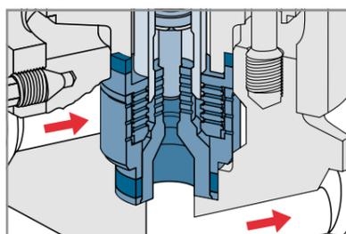
ZK 313: Steuerkolben in Regelstellung
