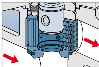
ZK 29: Steuerkolben in Regelstellung
