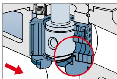
ZK 29: Schließstellung aufgehoben, Steuerkante des Kolbens gibt noch keine Bohrungen frei
