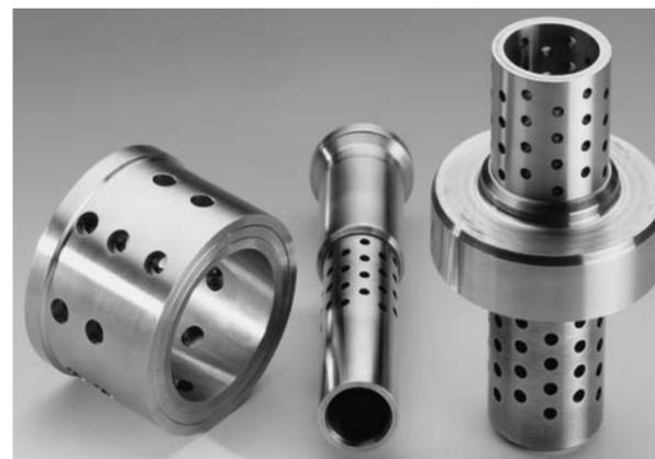
Innenteile eines Mindestmengenregelventils ZK 213, DN 100 nach 13 Jahren Betrieb
