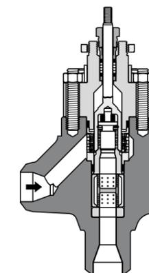
Sonderdüse  $\Delta p_{max}$  370 bar (auch in Durchgangsform)
