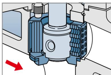
ZK 29: Steuerkolben in Schließstellung
