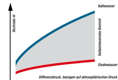
Steuerverhalten der ZK-RADIALSTUFENDÜSE®
