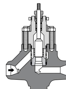
Sonderdüse  $\Delta p_{max}$  40 bar (ohne Tandemdüse)
