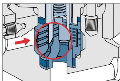
ZK 313: Schließstellung aufgehoben, Steuerkante des Kolbens gibt noch keine Bohrungen frei
