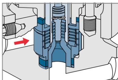
ZK 313: Steuerkolben in Schließstellung
