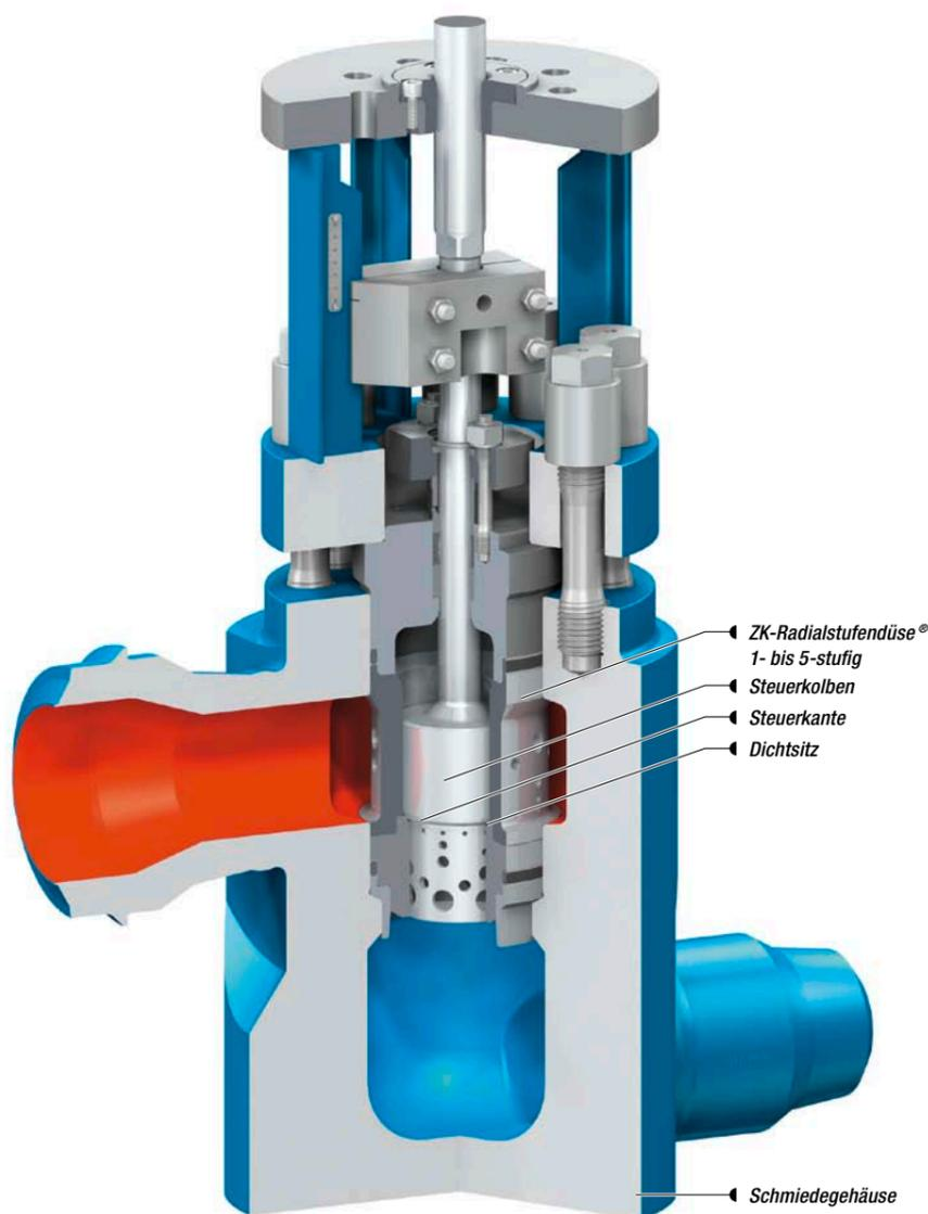
**Modulsystem der ZK-Radialstufendüse® für ZK 610, ZK 613**
