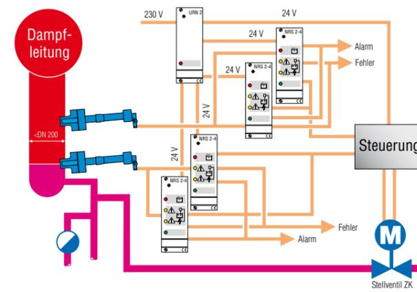
Geregelte Entwässerung mit einer 2 Sonden und optionalem Kondensatableiter
