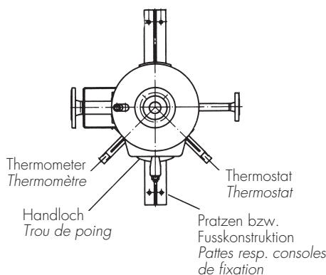
Das heiße Abwasser wird in das drucklose Mischgefäß geleitet und berührt hier den eingebauten Thermostaten. Gemäss der am Thermostaten eingestellten Temperatur öffnet ein Magnetventil und Kühlwasser fliesst zu.
